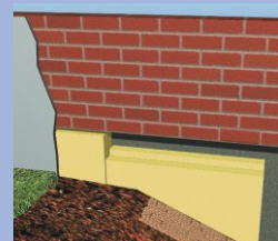
Изоляция стен подвалов
