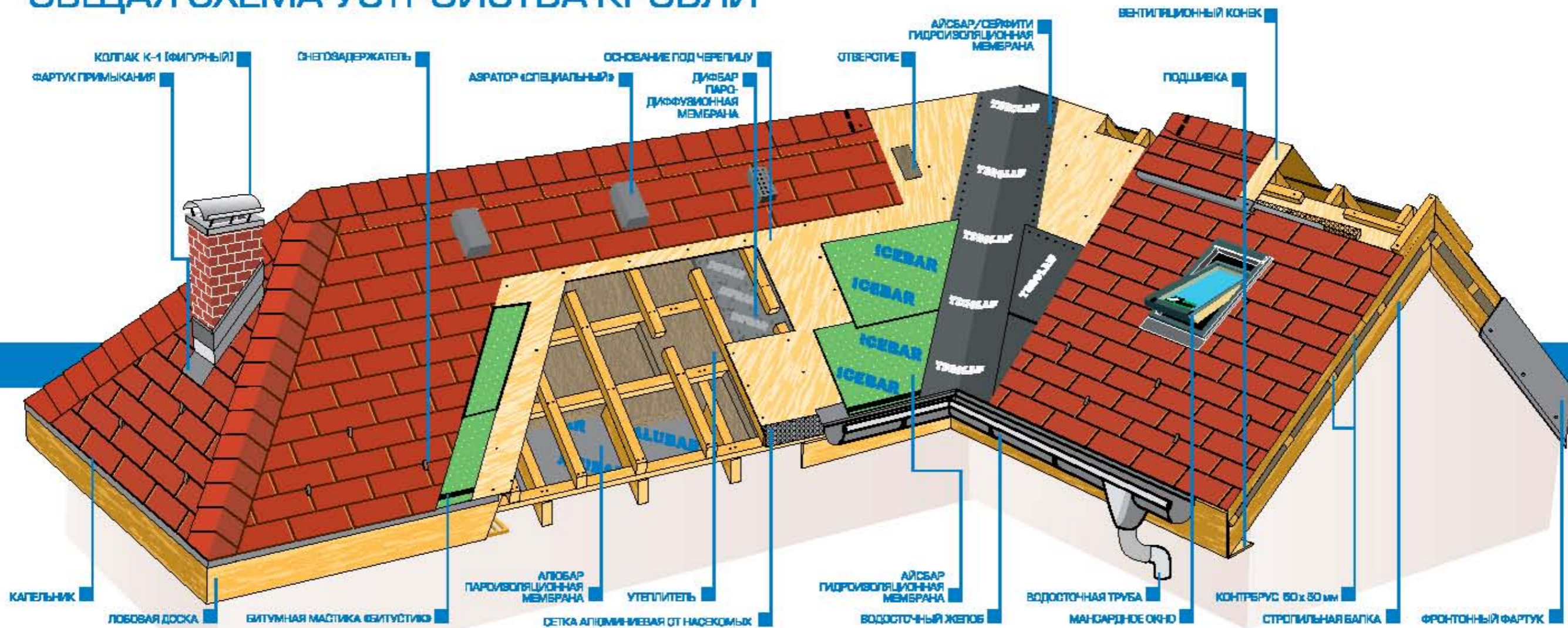
СТАНДАРТНАЯ ВЕНТИЛИРУЕМАЯ КРОВЕЛЬНАЯ КОНСТРУКЦИЯ ЖЕЛТОЙ МАНГАРДИ
