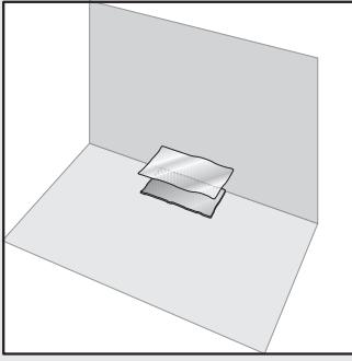
1 Подготовьте основание для установки цоколя. Для этого на увлажнённый пол уложите цементную подушку, выполните гидроизоляцию, нанесите цементный раствор.
