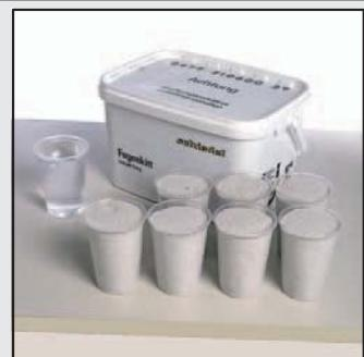
12 В случае применения сухой массы для заделки швов размещайте её точно в соответствии с прилагаемой инструкцией (7 частей массы и 1 часть воды). Последующие операции – см. рис. 13 и 14.
