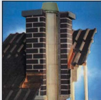
52 После облицовки дымохода в качестве завершающего элемента используйте покровную плиту и конус. Покровную плиту Вы можете получить в виде готового элемента или изготовить непосредственно на месте. В «Комплекте для монтажа верхней части дымовой трубы» содержится отдельная инструкция по бетонированию покровной плиты на строительной площадке.
