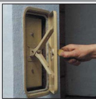
56 Удалить транспортный фиксатор с рычага дверцы и прижать внутреннюю часть дверцы путем закрывания наружной дверцы.
