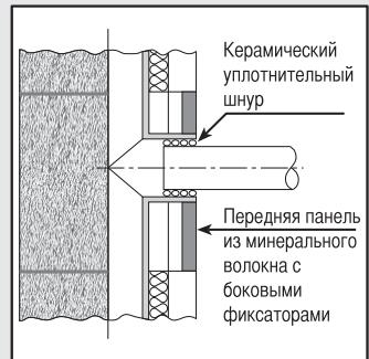
32 Зазор между внутренней поверхностью керамического тройника и трубой от потребителя уплотните керамическим шнуром.
